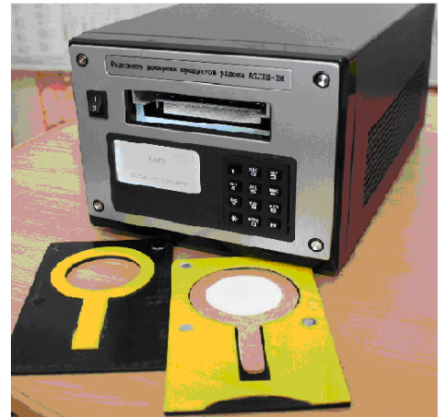
Рисунок 3.1 – Радиометр дочерних продуктов распада радона «АТЛЕШ-1м»: 1 – жидкокристаллический экран; 2 – ручка для переноса прибора и его установки в рабочее положение; 3 – панель управления; 4 – держатель кассеты с фильтром; 5 – кнопка включения/выключения; 6 – корпус прибора
