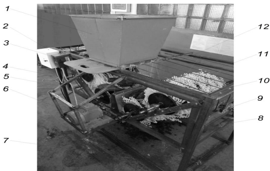
Рис. 1. Гофрощеточный очиститель кормовых корнеплодов:
