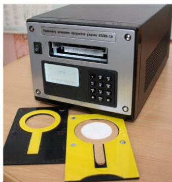
Рисунок 1.9 — Радиометр дочерних продуктов распада радона «АТЛЕШ-1м»: 1 — жидкокристаллический экран; 2 — ручка для переноса прибора и его установки в рабочее положение; 3 — панель управления; 4 — держатель кассеты с фильтром; 5 — кнопка включения/выключения; 6 — корпус прибора
