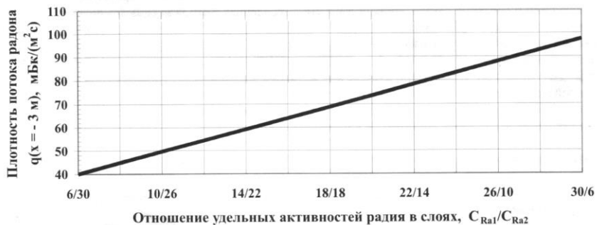
Рисунок 3.12 — Изменение плотности потока радона из грунта в зависимости от отношения удельной активности радия в верхнем слое к удельной активности радия в нижнем слое ( h_1 = h_2 = 3 \text{ м} ; k_{эм} = 0,5 ; \rho = 2000 \text{ кг}/\text{м}^3 ; D_{эф} = 7 \cdot 10^{-6} \text{ м}^2/\text{с} ; L_1 = L_2 = 1,826 \text{ м} )
