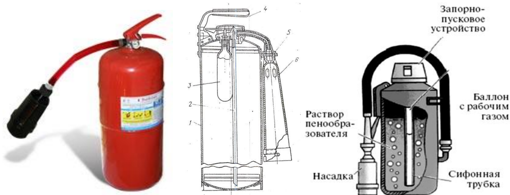
Рисунок 4.2 – Внешний вид и конструкция воздушно-пенного огнетушителя ОВП-10:
