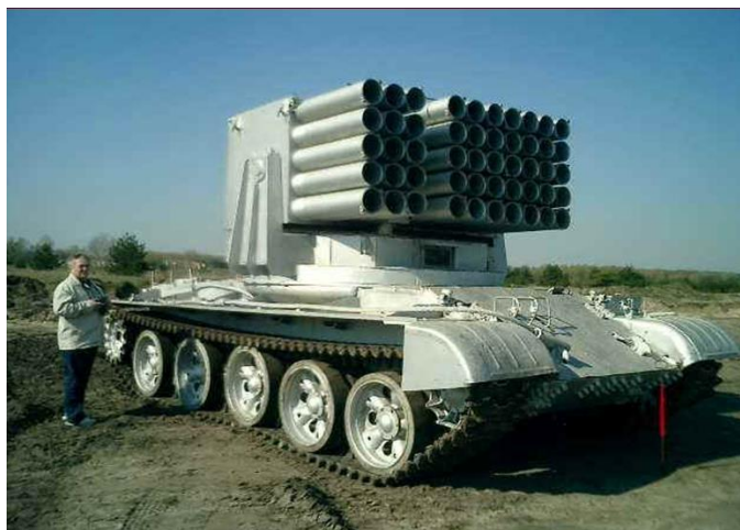
Рисунок 8.15 – Модуль автомобильный пожарный порошкового тушения
