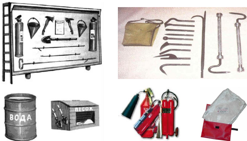
Рисунок 4.1 – Правильно оборудованный щит с противопожарным инвентарём
