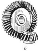
Рис. 2.6. Конічні передачі: а – прямозуба; б – косозуба; в – з криволінійним зубом
