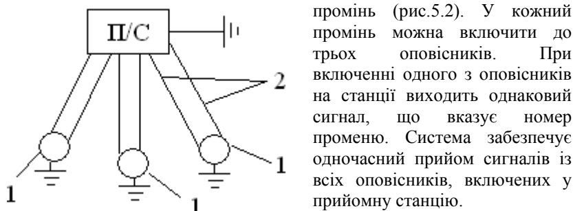
Рис. 5.2. Променева пожежна станція: 1 – оповісник, 2 – сполучні проводи, 3 – прийомна станція [10]
