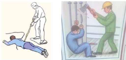
Рис. 7.4. Методи вивільнення з-під струму
