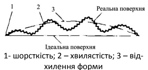
Рис. 15.1. Схема нерівностей поверхні
