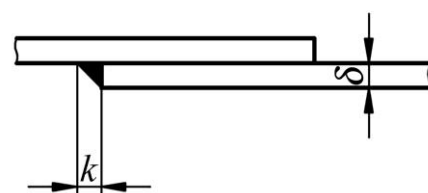
Рис. 20.15. Кутовий шов, навантажений моментом і силою
