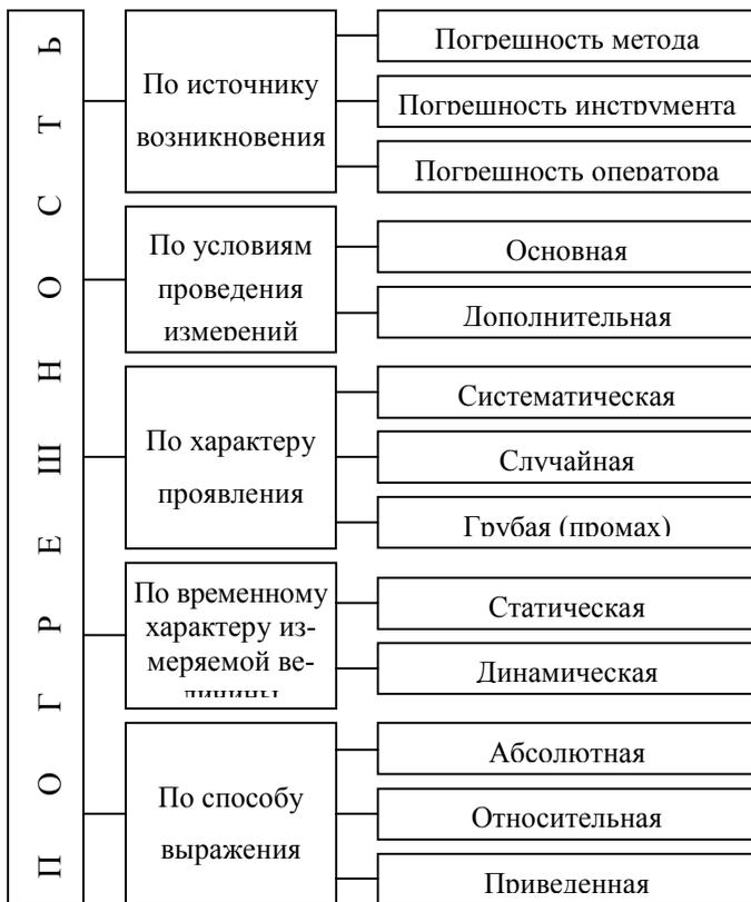
**ПОГРЕШНОСТЬ ИЗМЕРЕНИЯ** – отклонение результата измерения от истинного значения измеряемой величины.
