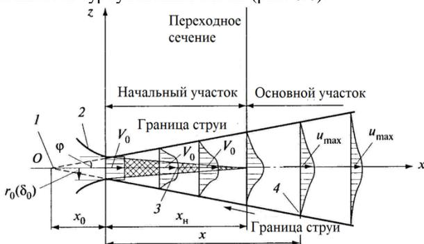
Рисунок 8.6 – Схема свободной турбулентной струи: 1 – полюс струи; 2 – насадок; 3 – ядро струи; 4 – граничный турбулентный слой
