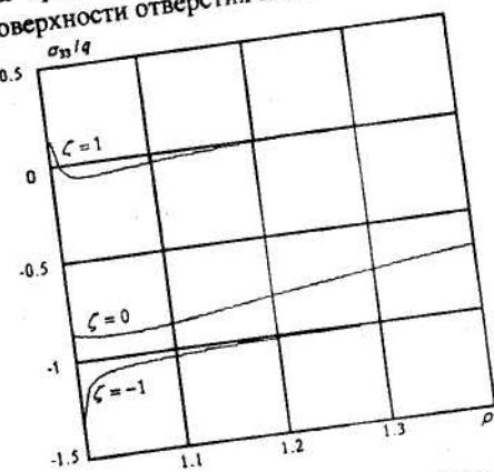
При возрастании координаты  $\rho$  напряжения  $\sigma_{33}$  на внешней (не нагруженной) поверхности  $\zeta = 1$  быстро затухают, приближаясь к нулю, а на внутренней (нагруженной) граничной поверхности  $\zeta = -1$  они стремятся к заданным значениям.
