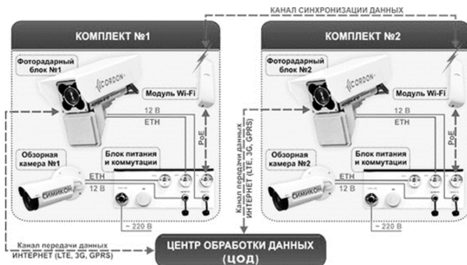
Рис. 1. Блок-схема комплекса «КОРДОН-М» КР с двумя комплектами оборудования [3]
