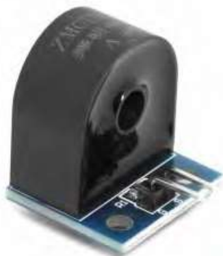
Рисунок 2. Внешний вид датчика тока ZMCT103C.
