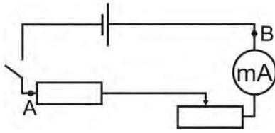
1. Соберите цепь по схеме (реостат-1100 Ом). Ползунок реостата поставьте в среднее положение. Замкните ключ. Запишите показания миллиамперметра
