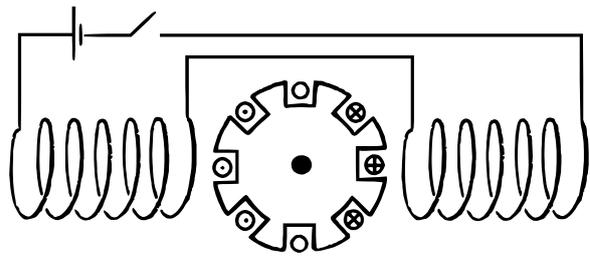
Мощность механическую:  $P_M = I \cdot U - I^2 \cdot R$ . КПД двигателя:  $\eta = \frac{P_M}{P}$
