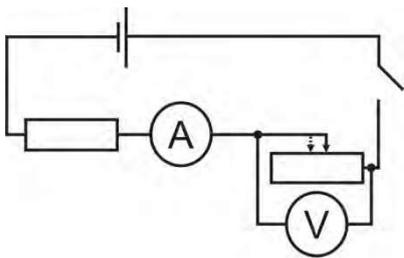
5. По формуле  $R = \frac{\rho \cdot l}{S}$  определите удельное сопротивление провода  $\rho$ . Формулы для расчетов:
