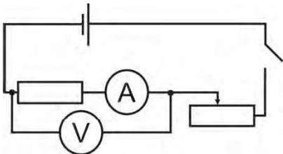
4. Соберите цепь по схеме. Реостатом установите минимальную силу тока. Запишите показания амперметра и вольтметра. Рассчитайте сопротивление реостата  $R = \frac{U}{I}$
