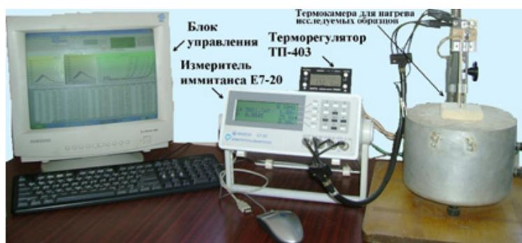
*Рис. 1. Измерительный стенд электрофизических параметров*
