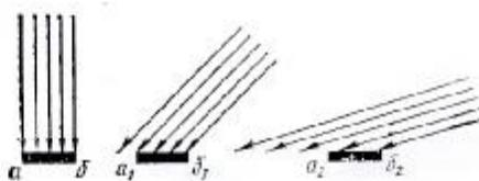
Рис.2. Зависимость нагревания поверхности от угла падения солнечных лучей. Площадь  $ab$ ,  $a_1b_1$  и  $a_2b_2$  одинаковые
