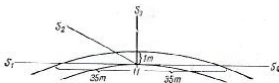
Рис. 3. Ослабление солнечной радиации в атмосфере в течение суток на экваторе: Н – точка наблюдения,  $m$  – число оптических масс,  $S_{1-4}$  – положение солнца
