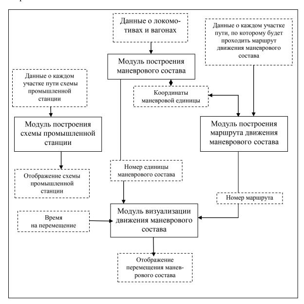
Рис. 1. Структура модели по визуализации перемещений маневровых составов
