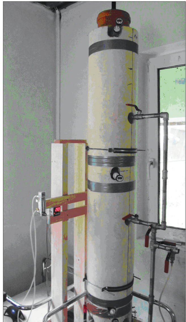
Рис. 2. Внешний вид экспериментальной установки для исследования переноса радона в пористых средах
