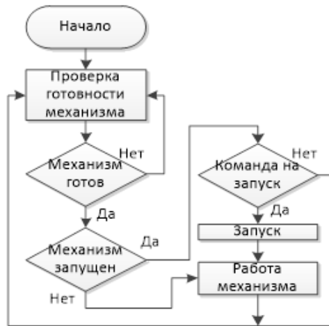
Рис 1 – Блок-схема упрощенного алгоритма управления механизмом.
