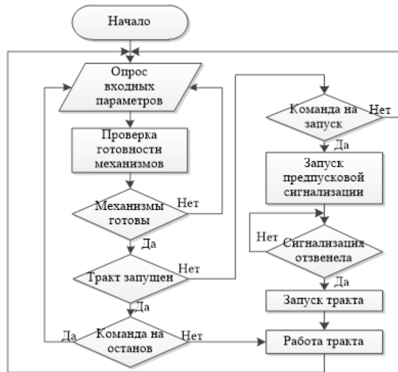
Рис 3 – Блок-схема упрощенного алгоритма управления трактом.
