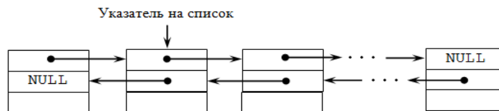
Рис.2. Структура двусвязного (двунаправленного) списка
