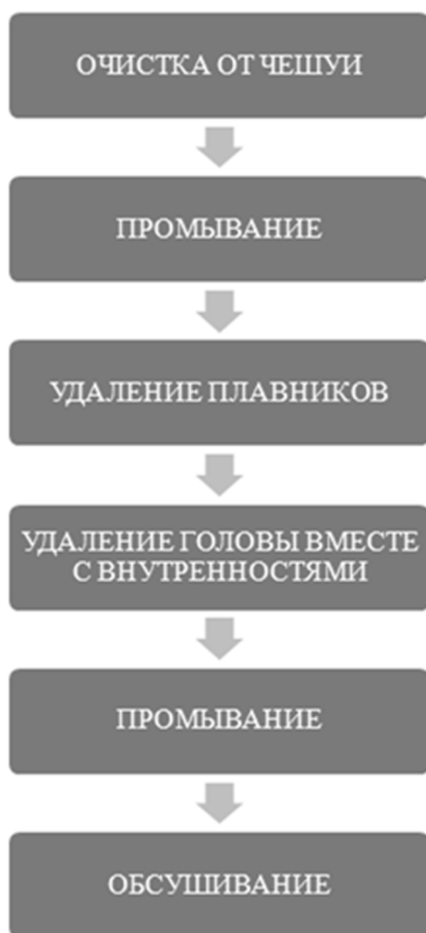
Рисунок Е.2 – Схема первичной обработки рыбы массой до 1,5 кг
