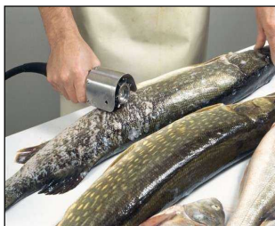
Рисунок 5.1. – Приспособления для очистки рыбы от чешуи: а – скребок для очистки рыбы, б – рыбоочистительная машина РО-1М
