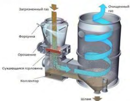
Рисунок 3.11 – Схема скруббера Вентури и принцип его работы: а – схема скруббера, б – принцип работы:
