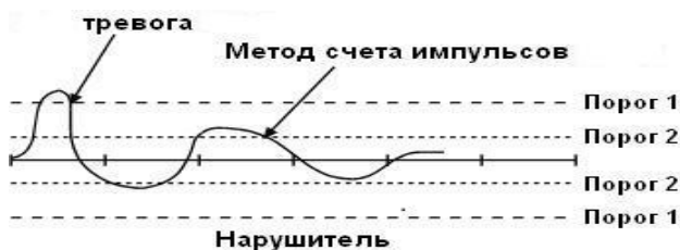
Рисунок 1 – Сигнал с извещателя при движении нарушителя
