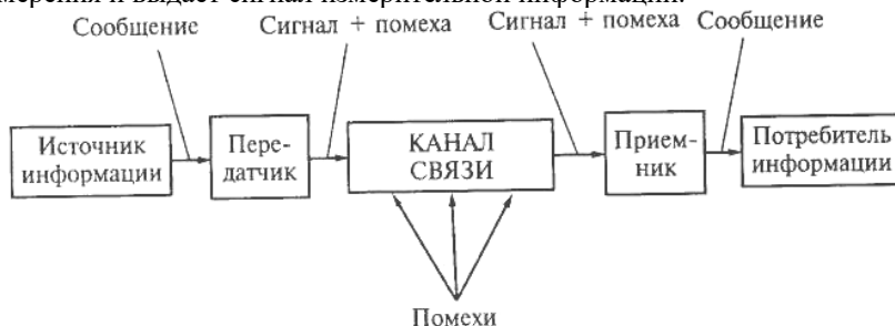
Рисунок 3.1 – Схема дистанционной передачи сигналов измерительной информации
