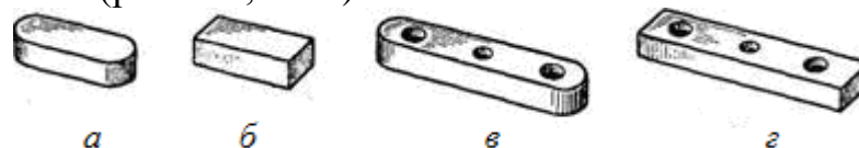
Рисунок 4.3 – Типы призматических шпонок: а и б – сплошные; в и г – с отверстиями
