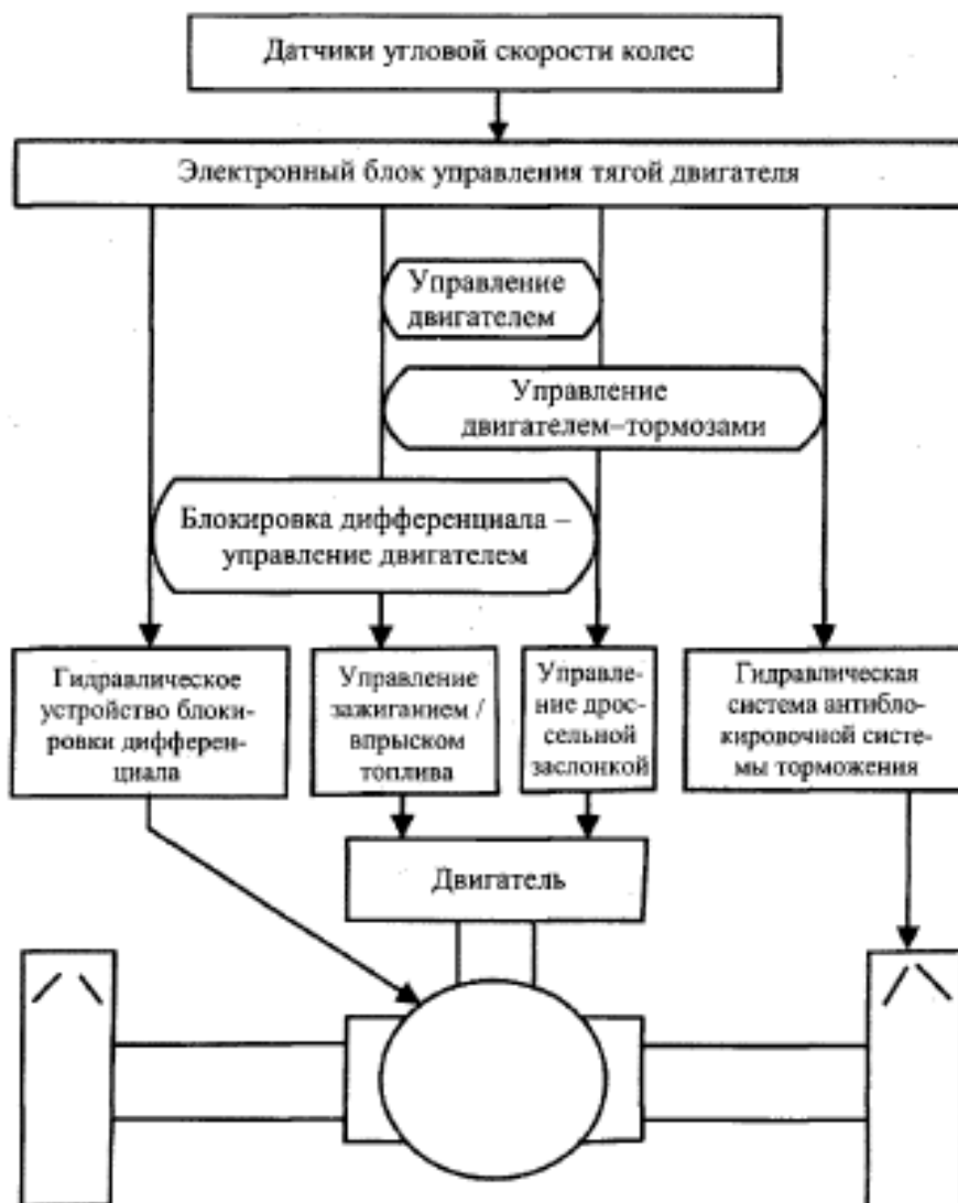
Рисунок 8.4 – Блок-схема вариантов противобуксовочной системы
