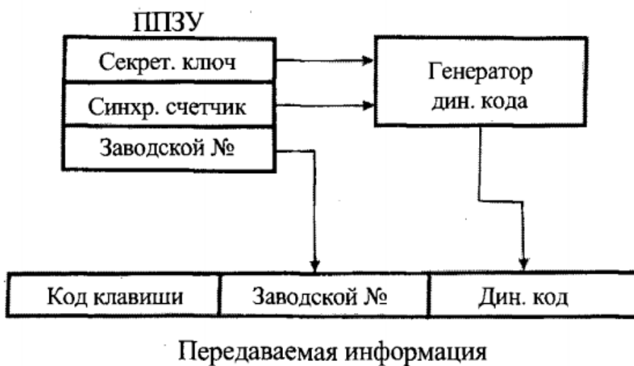
Рисунок 6.1 – Алгоритм работы передатчика (брелок)
