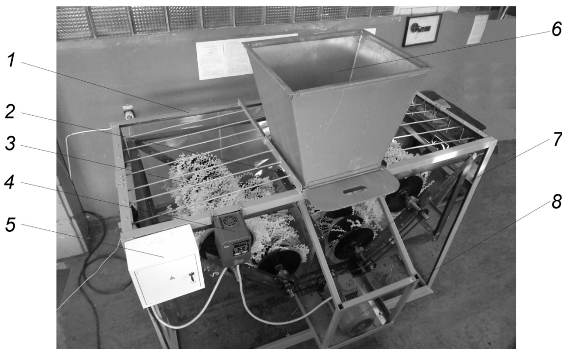
Рис. 1. Конструкция гофрощёточного очистителя кормовых корнеплодов: 1 – рама; 2 – заслонка регулируемая; 3 – комплект верхних щеточных барабанов; 4 – инвертор; 5 – пульт управления; 6 – загрузочный бункер с заслонкой; 7 – комплект нижних щеточных барабанов; 8 – привод
