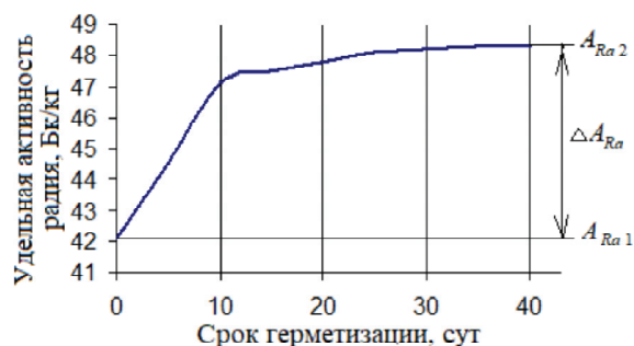
Рисунок. Определение коэффициента эманирования угольного аргиллита
