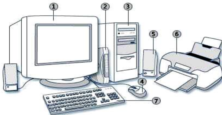
Рис. 1.1. Основные технические средства персонального компьютера: 1 – монитор, 2 – модем, 3 – системный блок, 4 – мышь, 5 – динамик, 6 – принтер, 7 – клавиатура
