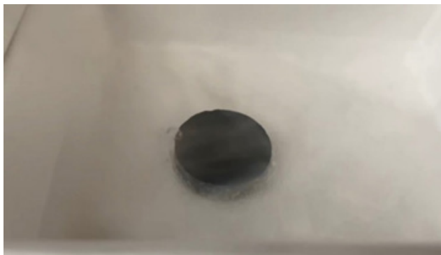
Рис. 1. Охлаждение сверхпроводника жидким азотом.
