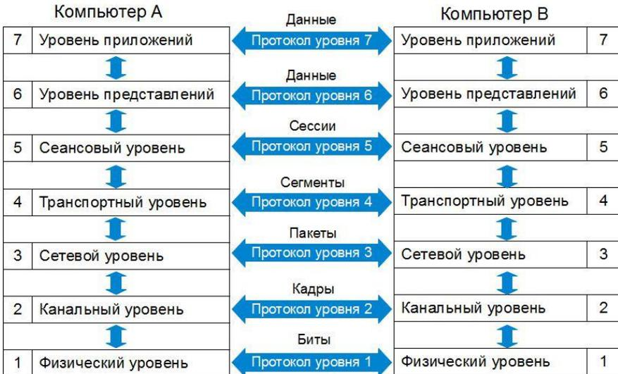
Рисунок 2.2 – Схема взаимодействия компьютеров в базовой эталонной модели OSI
