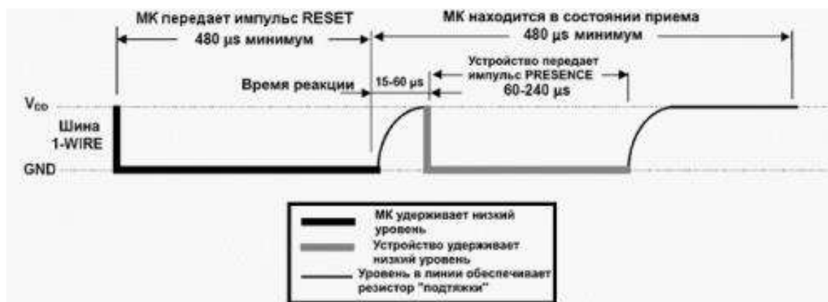
Рис. 8.4. Временная диаграмма обмена данными микроконтроллера по протоколу 1-Wire
