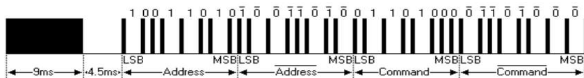
Рис. 7.5. Кодировка сигнала по протоколу NEC
