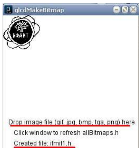
Рис. 6.4. Отображение рисунка в программе glcdMakeBitmap с указанием поддерживаемых форматов и имени созданного файла
