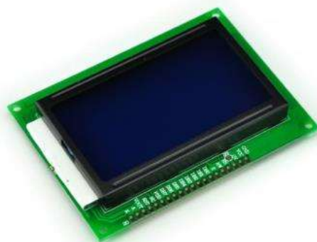
Рис. 5.1. ЖКИ WG12864A на базе контроллера KS0107
