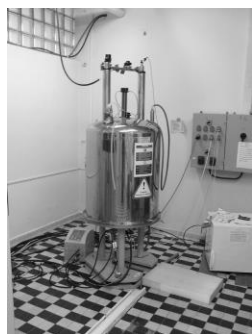
Рис. 2. Слева: современный ЯМР-прибор «Bruker Model DRX 400» (рабочая частота прибора 400 МГц). Справа: ПМР-спектр 4-гидрокси-4-метилпентан-2-она – 1) в герцах; 2) по шкале \delta ; 3) по шкале \tau
