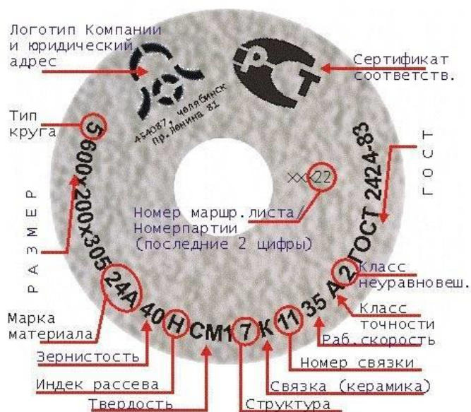
Рисунок 8.3 – Маркировка шлифовального круга
