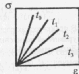
б) изохроны \sigma - \varepsilon ( t_n > \dots > t_2 > t_1 > t_0 )
