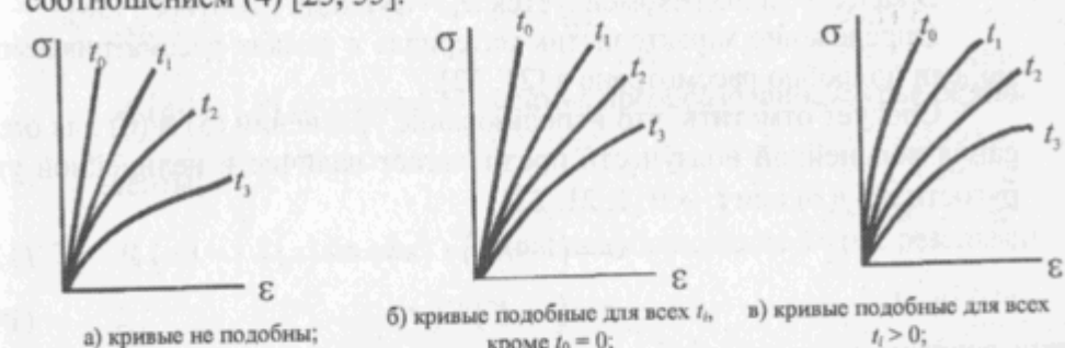
Рис. 14 – Кривые зависимости «напряжение – деформация» \sigma \sim \epsilon в различные моменты времени t_i
