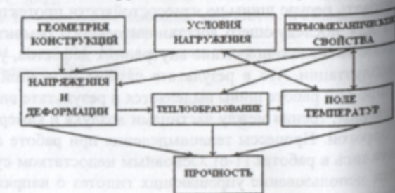
Рис. 1 – Схема решения связанной задачи термоупругости
